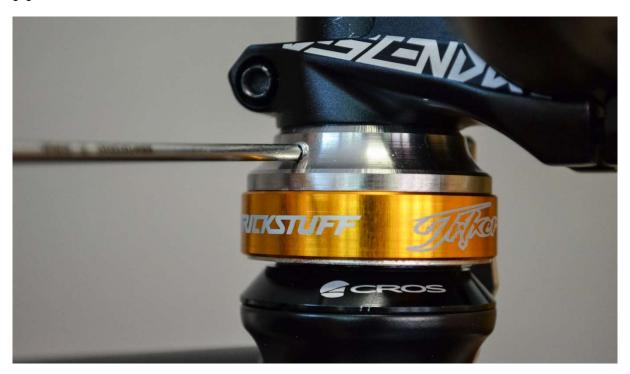
Die vom Bremshebel kommende Leitung mit einem Anschluss versehen und in den oberen Leitungsabgang einschrauben. Schließen Sie die Leitung zum Bremssattel an den unteren Leitungsabgang an. Eine detaillierte Anleitung für das Trickstuff-Trixer-Connection-Kit finden Sie HIER
